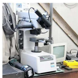
田尻工場 マイクロピッカース硬さ計
